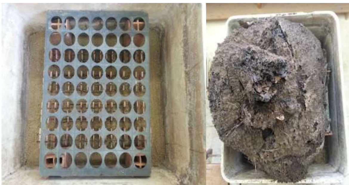
Figura 10 – Disposição da colônia de térmitas em ensaio biológico de preferência alimentar.
