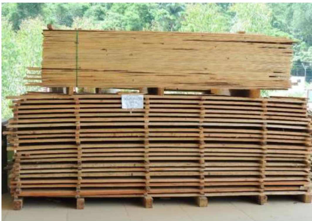
Figura 6 – Pilha de secagem tipo caixa com restrição na camada superior.
