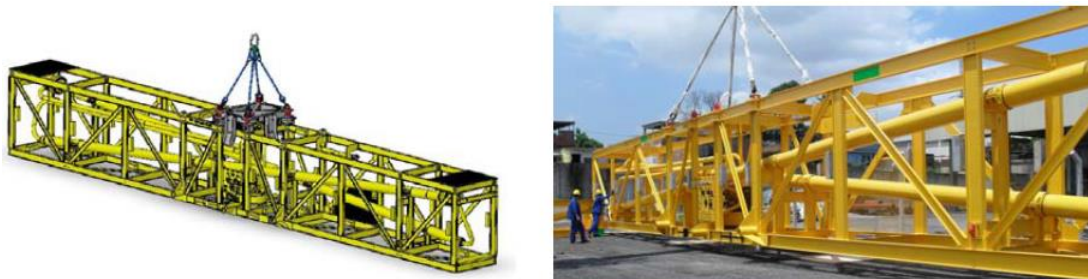
Figura 11 – Representação esquemática do módulo de bombeio (esquerda) e o desenvolvido para o campo de Espadarte (direita).
