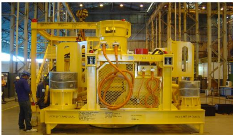
Figura 7 – Base Adaptadora de Bombeio.
