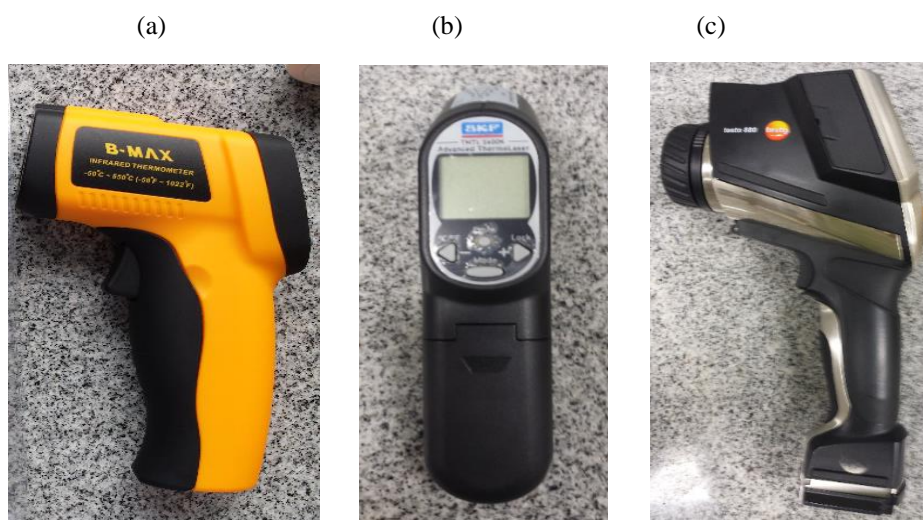
Figura 3.4 - Instrumentos para monitoramento da temperatura das amostras de pipoca. Sendo (a) e (b) termômetros infravermelhos e (c) câmera termográfica.
