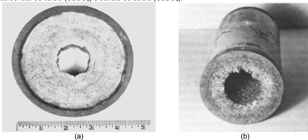
Figura 2 - Exemplos de incrustação de (a) carbonato de cálcio com elevado grau de pureza e de (b) carbonato de cálcio ( \text{CaCO}_3 ) e sulfato de cálcio ( \text{CaSO}_4 ).
