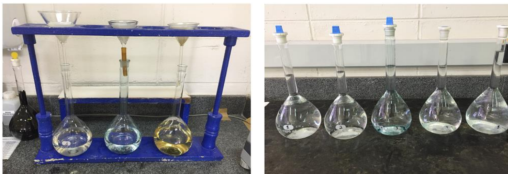
Figura 22 - Amostras filtradas e diluídas em 1 litro de água desmineralizada
