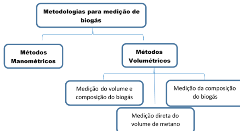
Figura 3- Representação da divisão dos métodos de medição de biogás.
