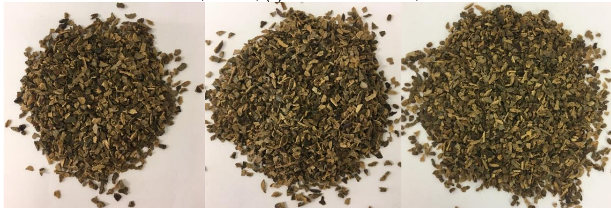
Figura 3.1 - Amostras da casca de cacau: (a) diâmetro médio 2,03 mm; (b) diâmetro médio 1,55 mm; (c) diâmetro médio 1,29 mm.
