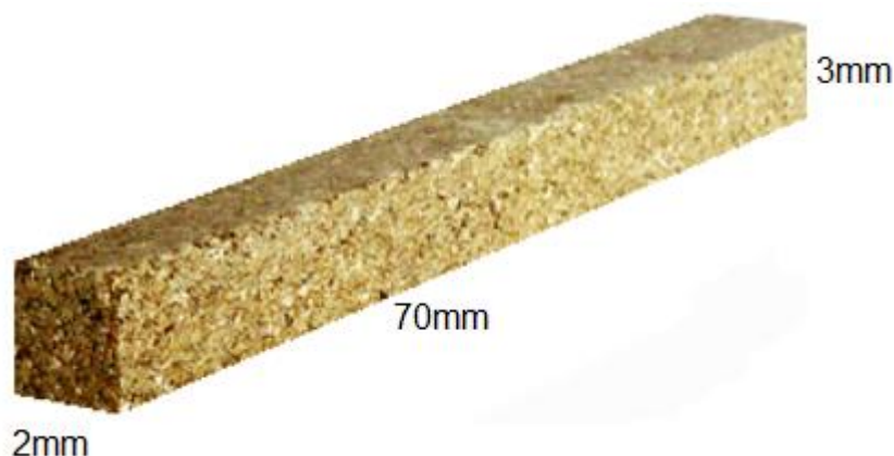
Figura 11 - Tijolo cortado pronto para ser acoplado à chapa de aço
