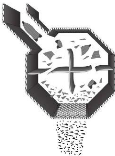
FIGURA 9. Modelo esquemático do moinho Retsch SM 300 utilizado na trituração do PET [12] .
