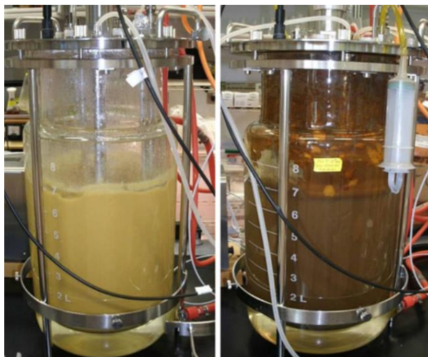
Figura 4: Cultivo de Heterorhabditis. bacteriophora em meio líquido. À esquerda encontra-se um fermentador com o meio líquido antes da inoculação com a bactéria simbiote Photorhabdus , e à direita, o mesmo meio, após 21 dias de cultivo dos nematoides (INMAN; SINGH; HOLMES, 2012).
