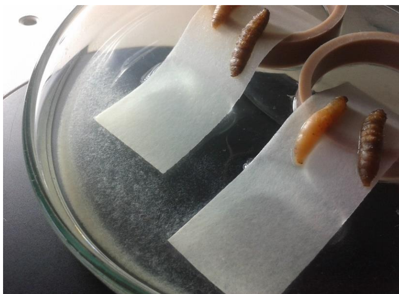
Figura 3: Armadilha de White (1927) modificada, constituída de anel de PVC (25 mm de diâmetro e 50 mm de altura), papel filtro e água.
