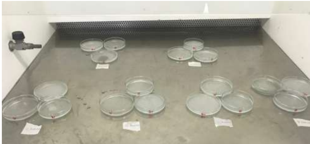
Figura 1- Disposição das placas de Petri® contendo as emulsões dos três óleos, para exposição por até 12 horas, à luz UVC (240 nm).
