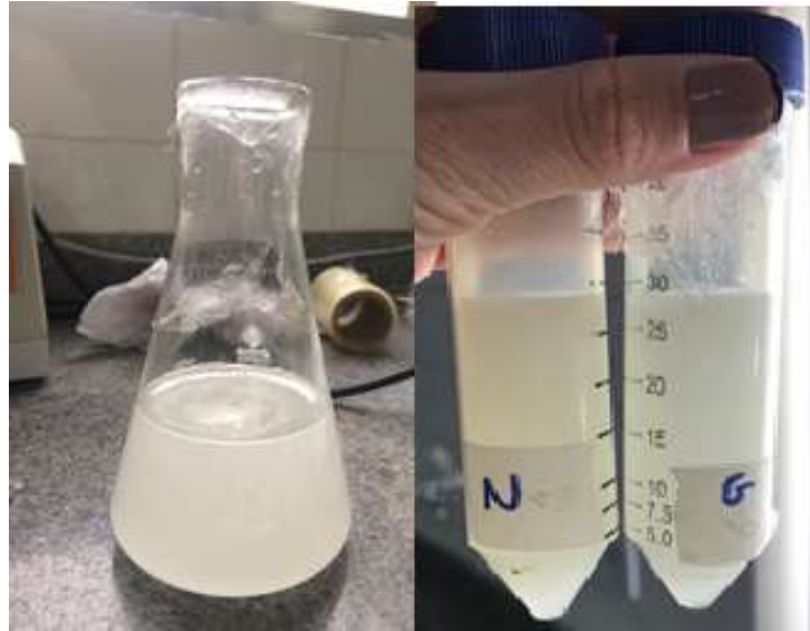
Figura 6- Emulsões sem separação de fases dos óleos de Zingiber officinale , Azadirachta indica e Annona muricata , respectivamente, após 24 horas de repouso.
