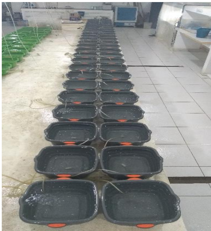
Figura 1 -Sistema estático com aeração constante por meio de pedra porosa. Fonte: o autor.
