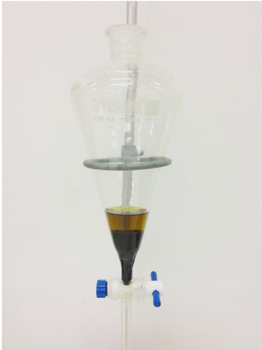
Figura 20 - Funil de separação contendo as duas fases obtidas após a reação de transesterificação.
