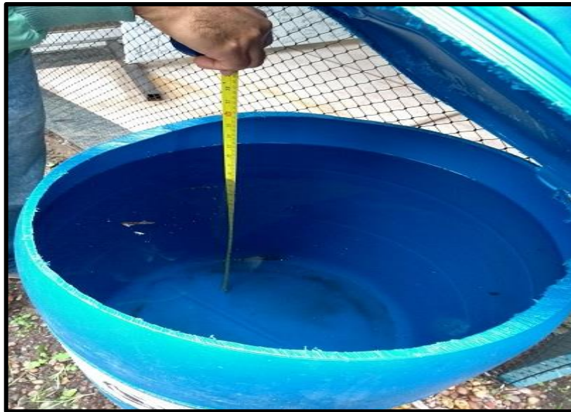
Figura 16 – Aferição da altura de lâmina d'água com base no centro do reservatório Fonte: Elaborado pelo autor (2017).
