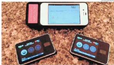
Sensor libera leitura para smartphone, que calcula dose de insulina a cada 5 minutos
