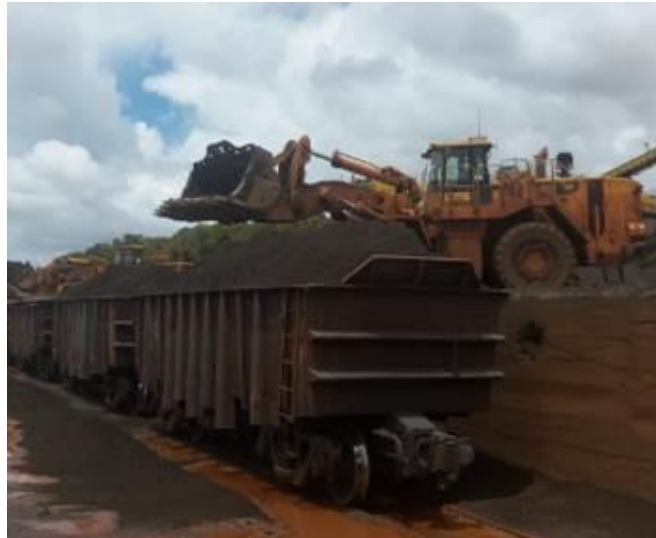
Figura 4: Exemplo de carregamento de minério de ferro por pá mecânica
