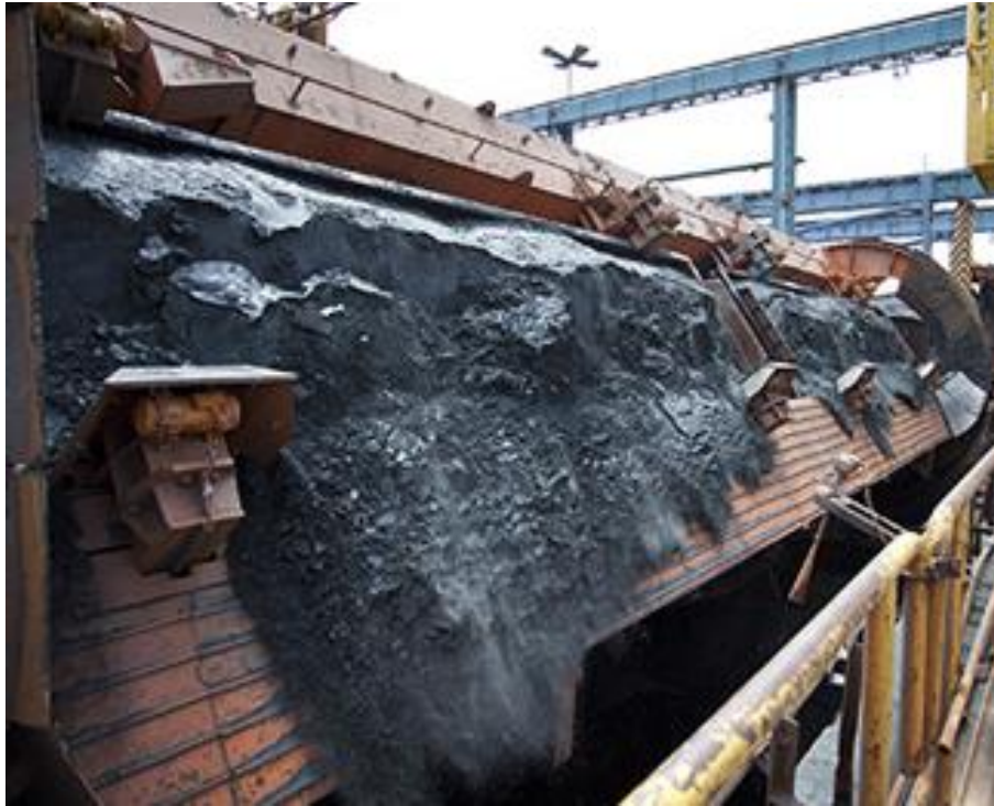
Figura 15: Vagão de minério de ferro em processo de descarga em um dos viradores do Porto de Tubarão
