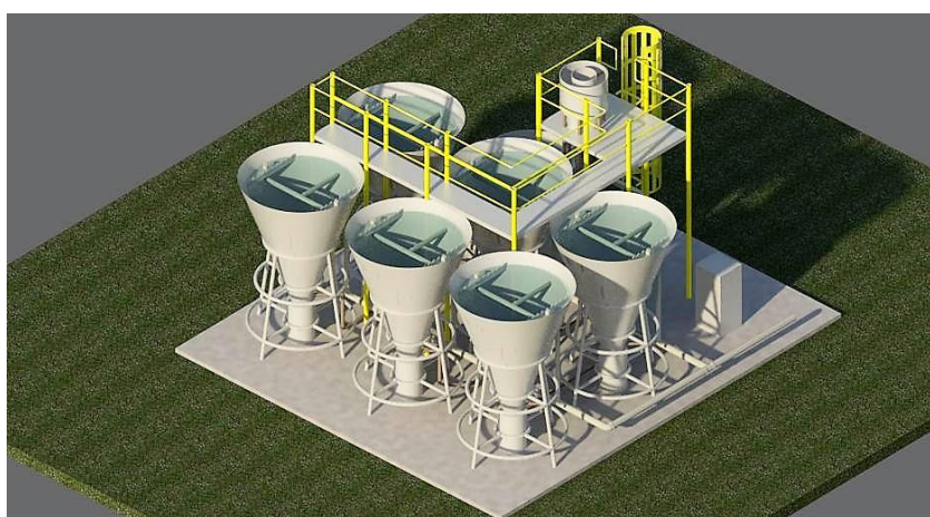
Figura 35 - Desenho do cristalizador proposto pela Fluir Engenharia
