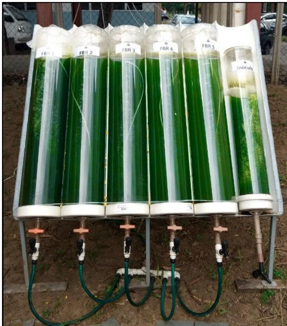
Figura 5 – Fotobiorreatores de cultura microalgácea em efluente de tratamento de esgoto doméstico. Cultivos em ambiente externo sob iluminação natural e aeração artificial.
