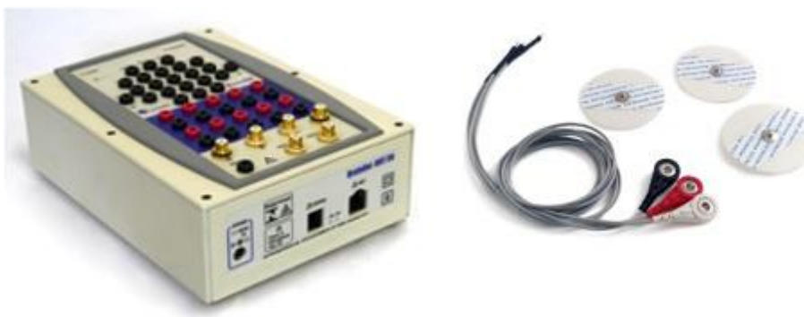
Figura 7: Brainnet e sensores de EMGs, responsáveis pela aquisição de sinais mioelétricos (sEMG).
