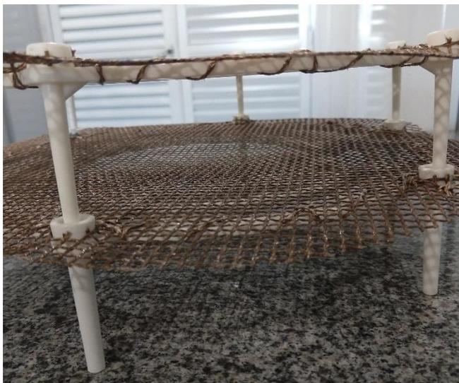
**Figura 2** – Bandeja de dois andares para secagem em forno de micro-ondas.
