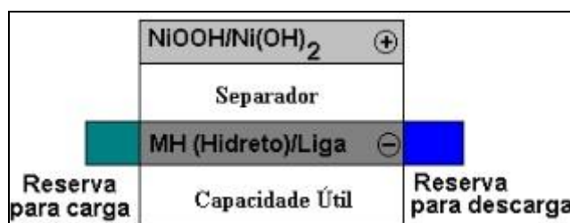
Figura 2: Esquema de uma bateria de Ni-MH.
