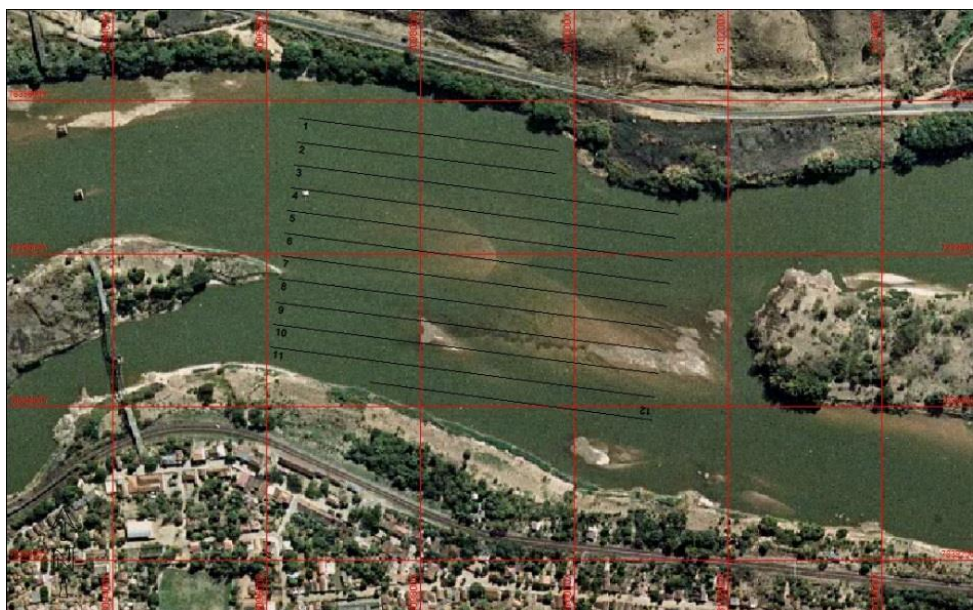
Figura 8 – Vista superior do trecho com linhas longitudinais para levantamento batimétrico.
