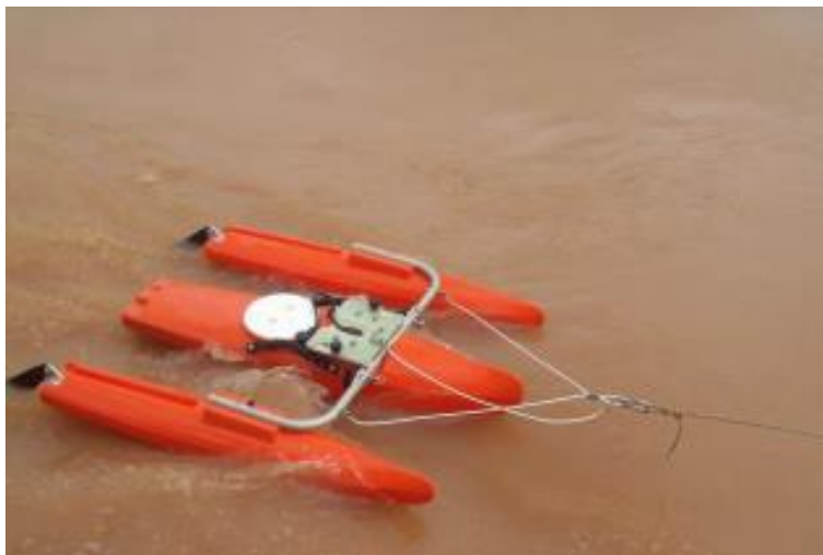
Figura 9 – Aparelho ADCP RDI RiverRay em funcionamento.
