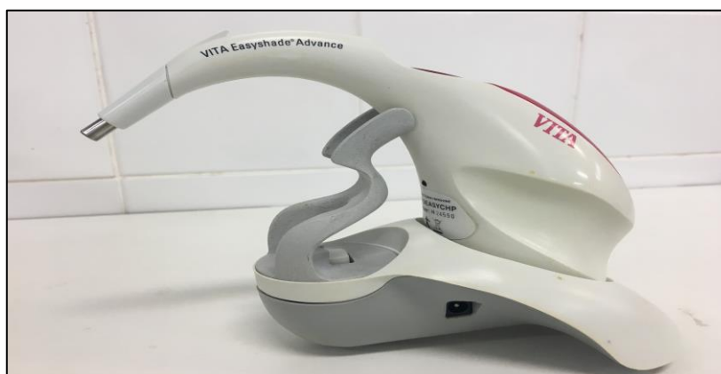
Figura 02. Espectrofotômetro (Vita EasyShade® Advance).
