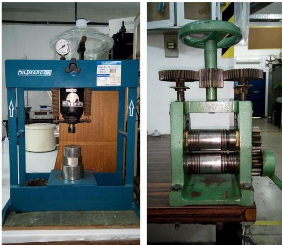
Figura 3.2 – Imagem da prensa hidráulica (foto do lado esquerdo), que amassou as amostras fundidas inicialmente e do laminador (foto do lado direito) que transformou a “esfera” amassada em fitas das ligas  $Fe_2Mn(Ga_{1-x}Al_x)$  com  $0 \leq x \leq 1$ .
