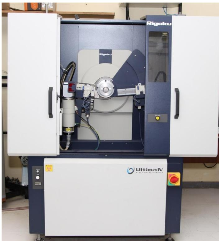
Figura 3.5 – Difratorômetro de raios-X da marca Rigaku.
