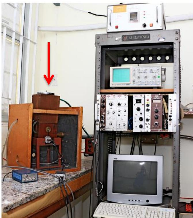
**Figura 3.3 – Imagem do Forno Mössbauer utilizado para tratamento térmico em temperaturas até  $773 K$  (baixas temperaturas).**
