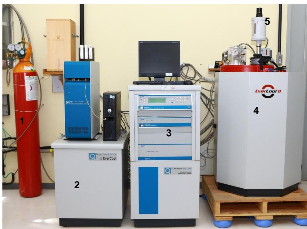
Figura 3.7 – O sistema PPMS®. (1) cilindro de Hélio, o (2) sistema de controle de gás, o (3) sistema de controle eletrônico, o (4) dewar e o (5) VSM.
