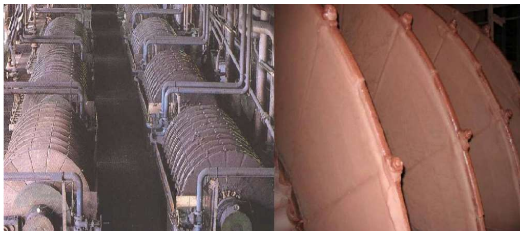
Figura 58 – Filtros de Disco Rotativo a Vácuo e Formação de Torta no Elemento Filtrante.
