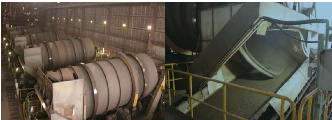
Figura 61 – Exemplo de Tambor de Pelotamento.
