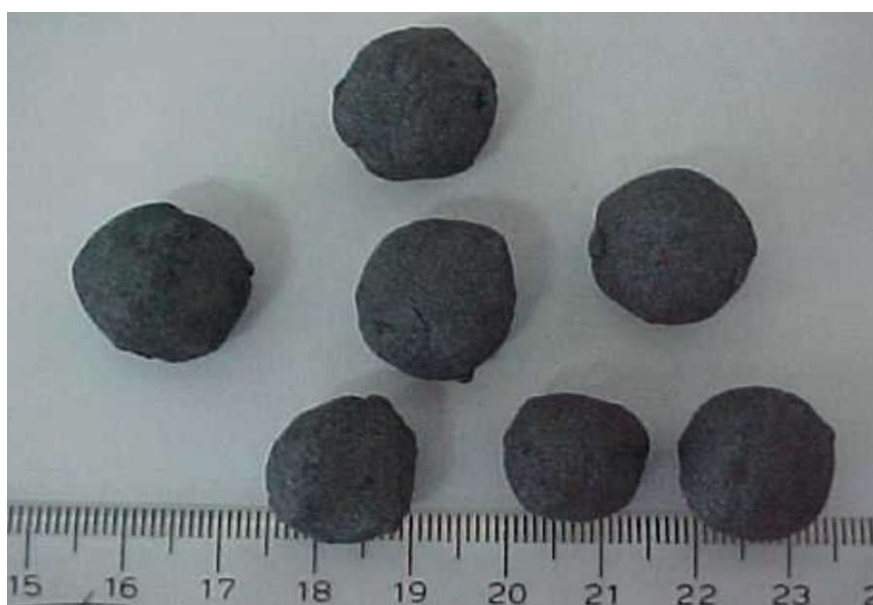
Figura 68 – Pelotas de Minério de Ferro: Produto Final da Pelotização.
