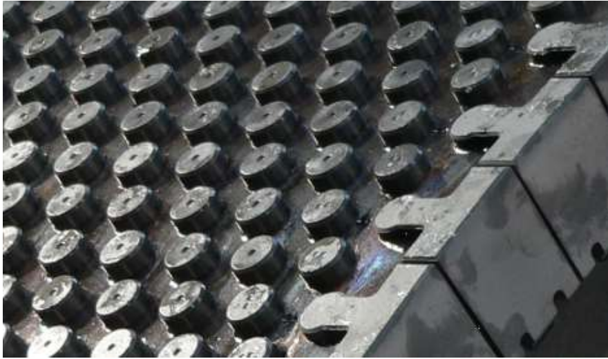
Figura 14 – Detalhe dos studs
