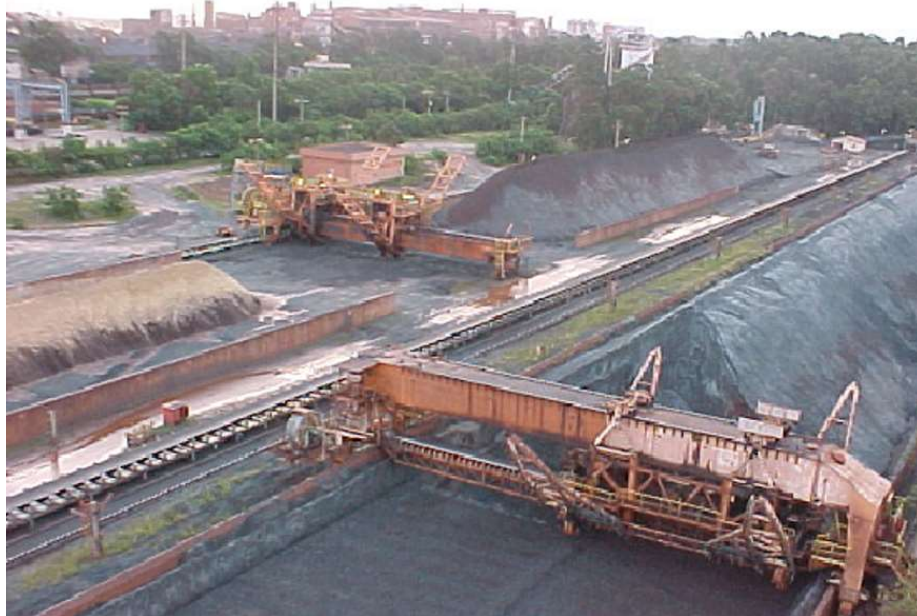
Figura 53 – Pátios de Finos e Recuperadoras de minério de ferro.
