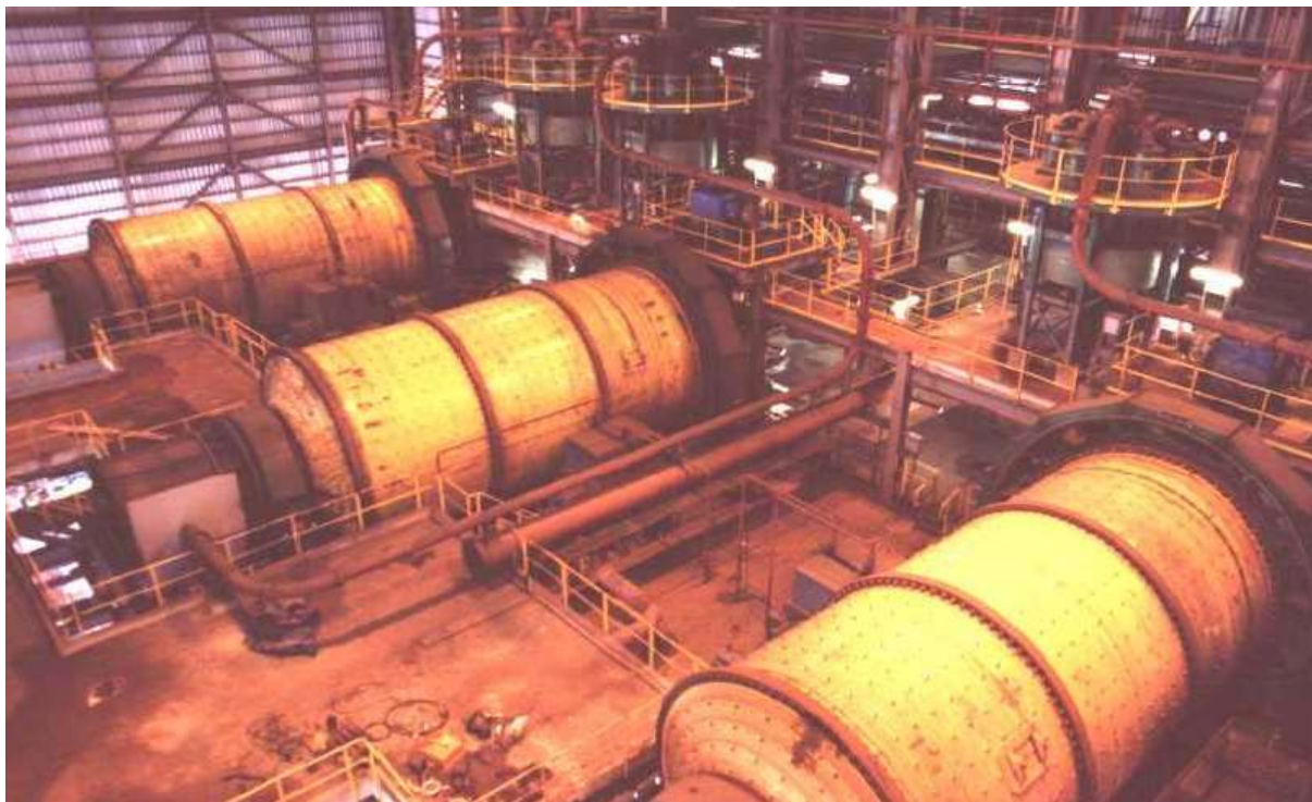
Figura 54 – Moinhos de bolas em uma usina de Pelotização.
