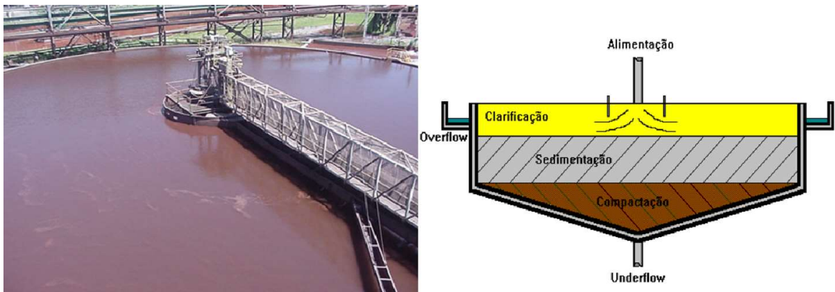
Figura 56 – Espessador e Fases do Espessamento: Clarificação, Sedimentação e Compactação.
