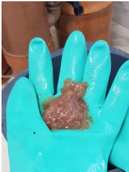
Figura 24 – Parte da biomassa que promoveu a obstrução do Piloto II.
