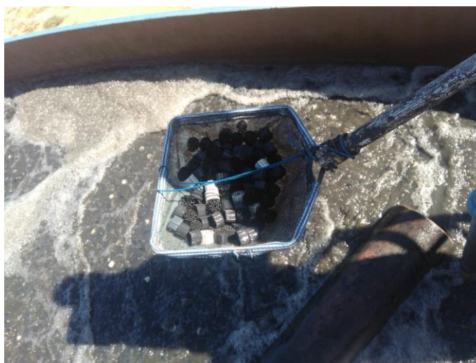
Figura 10 – Meio suporte retirado da ETE do tipo MBBR em Aracruz/ES.
