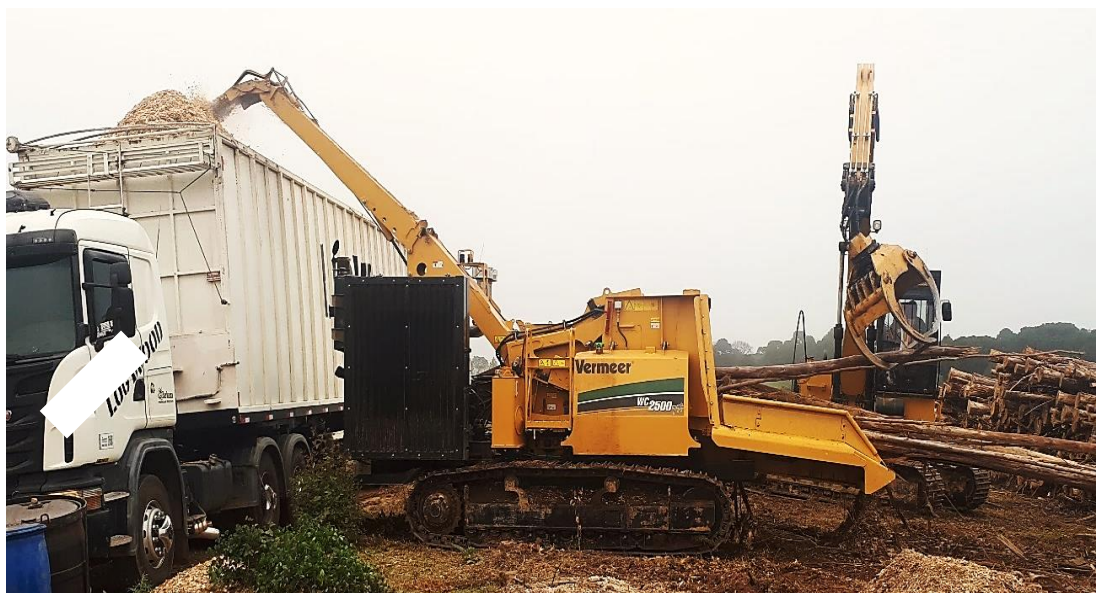
Figura 2. Picador processando a madeira depositando o cavaco diretamente na carreta e sendo alimentado por um carregador. FONTE: a autora.
