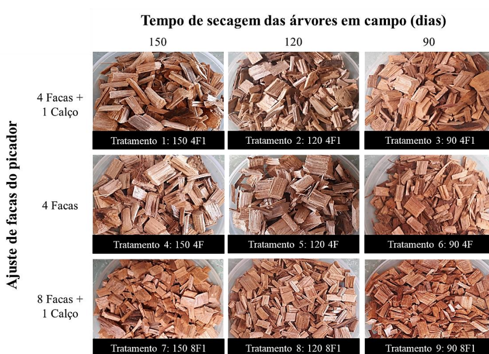
Figura 4. Matriz dos tratamentos estudados na pesquisa, resultantes da interação entre três tempos diferentes de secagem das árvores em campo vs três ajustes diferentes de facas no picador. FONTE: a autora.
