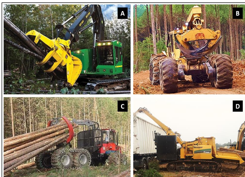
Figura 1. A – Feller-buncher ; B – Skidder Convencional; C – Skidder Clambunk ; e D – Picador . FONTE: a autora.
