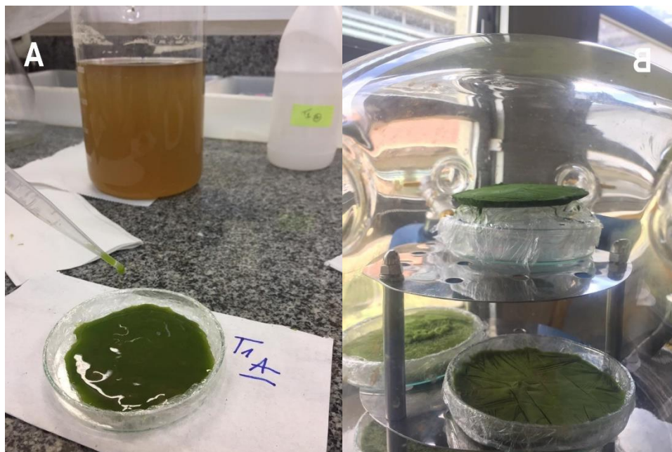
Figura 5. A. Biomassa extraída do tratamento com 10% de vinhaça ao final do cultivo. B. Biomassa liofilizada. Fonte: Autor (2018).
