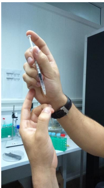
Figura 7: Momento de preenchimento do eletrodo com solução de eletrólito (15 mM KCl e 40 mM \text{KH}_2\text{PO}_4 , pH 6.0, para \text{H}^+ ; 100 mM KCl para ânions e potássio; 100 mM \text{CaCl}_2 para \text{Ca}^{2+} ) correspondente a uma coluna de 1,5 mm do eletrodo (Foto: Arquivo pessoal).
