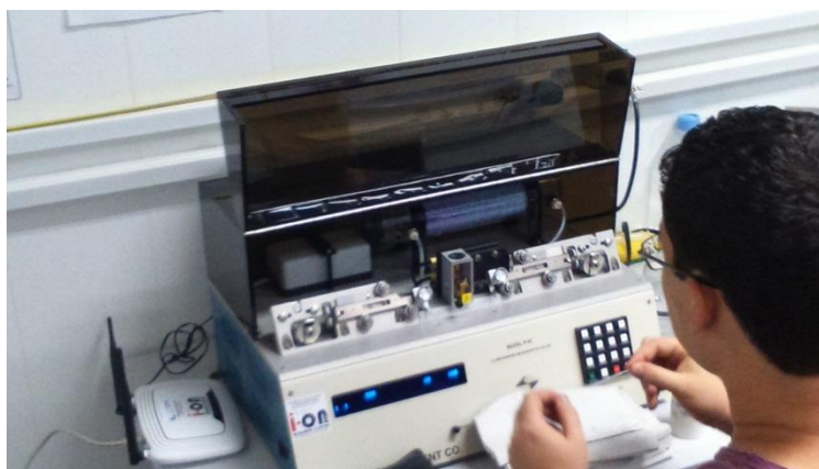
Figura 6: Momento da confecção dos microelétrodos de borosilicato a partir do equipamento Puller Flaming Brown, Sutter P-98 ( Sutter Instruments, Novato, CA ) (Foto: Arquivo pessoal).
