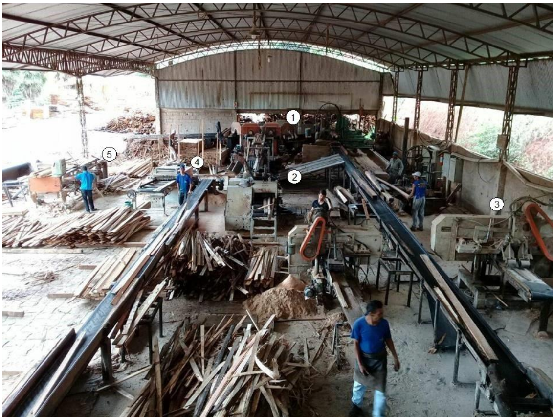
Figura 4– Visão geral da linha de produção de madeira serrada 1: serra de fita geminada – produção de um semibloco e duas costaneiras; 2: serra circular múltipla resserradeira (dois eixos) – produção de tábuas e duas costaneiras; 3: serra de fita horizontal de reaproveitamento de costaneiras – produção de uma tábua não refilada; 4: serra circular refiladeira – produção de tábuas; 5: mesa de destopamento – regularização do comprimento das tábuas.
