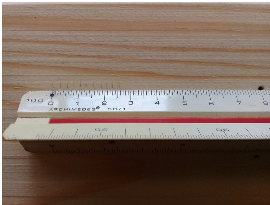
Figura 8 – Medição do número de marcas presentes ao longo de 25 mm lineares em deck de Pinus elliottii .
