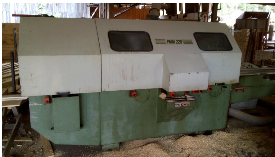
Figura 4 – Plaina moldureira S4S da marca Omil, modelo PMM-220 5° E.
