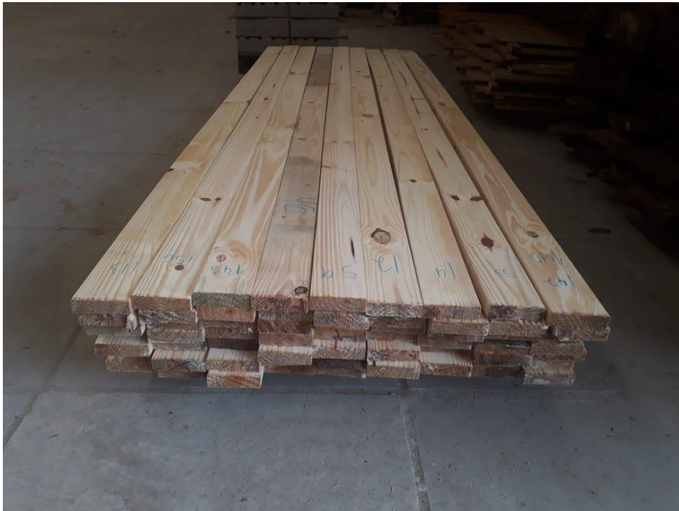
Figura 6 – Peças aplainadas de decks de Pinus elliottii .
