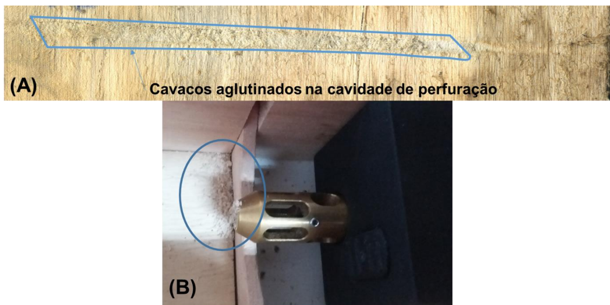
Figura 6 - Solidificação dos cavacos (marcação em azul) na cavidade de perfuração em amostras que foram perfuradas quando saturadas (A); escoamento de cavacos (círculo azul) após a perfuração do resistógrafo em amostra com teor de umidade de equilíbrio higroscópico (B)
