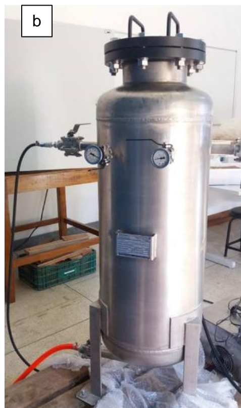
Figura 8. a) Representação do corpo-de-prova de delaminação (unidade em cm); b) Autoclave utilizada.
