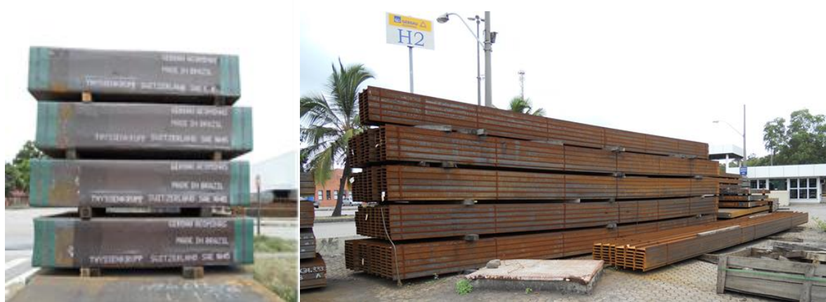
Figura 1. Calços de madeira no armazenamento de chapas de aço e perfis metálicos.
