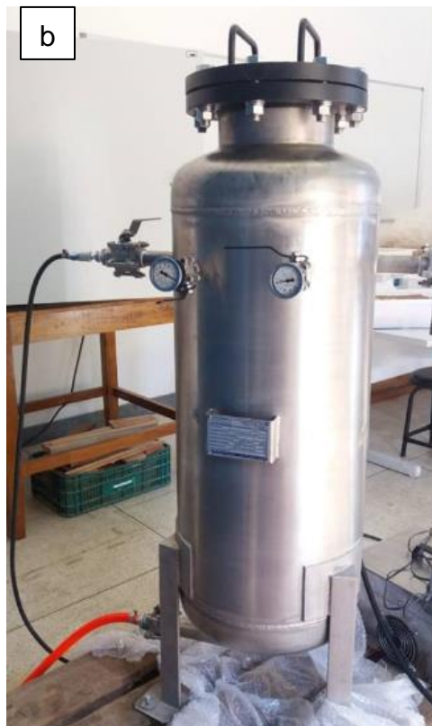
Figura 7. a) Representação do corpo de prova de delaminação (valores em cm). b) Autoclave utilizada.
