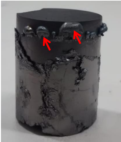
Figura 32 – Fase líquida no topo do punção indicada pela seta vermelha.
