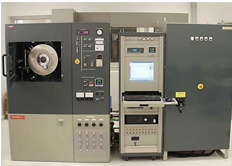
Figura 31 – Máquina de Sinterização SPS.
