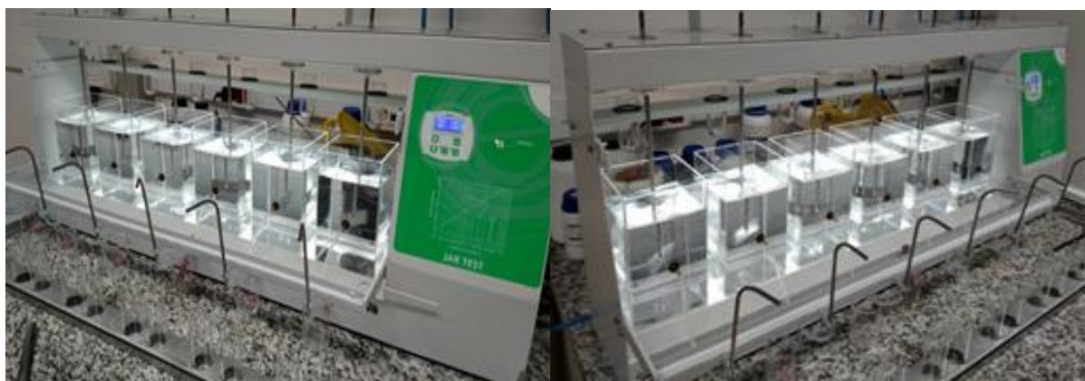
Figura 9: Equipamento de Jar Test utilizado para o teste de jarros durante o processo de coagulação química do efluente sintético na remoção de Boro.
