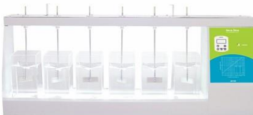
Figura 6: Representação de um equipamento de Jar Test utilizado para a coagulação química de efluentes.
