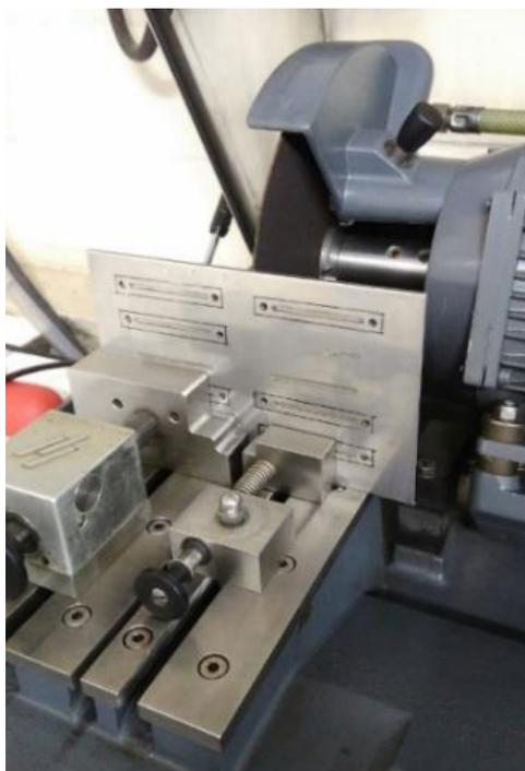
*Figura 18 - Corte dimensional da chapa de aço inoxidável.*
