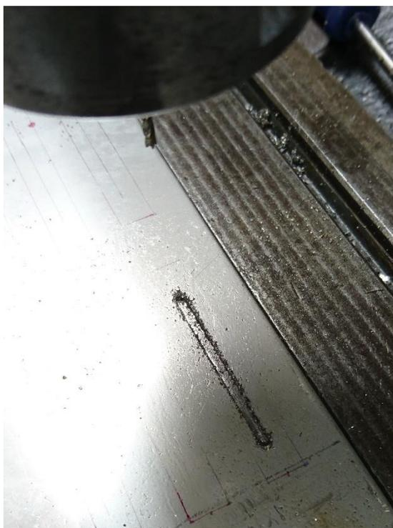
*Figura 17 - Usinagem da cava na chapa de aço inoxidável.*
