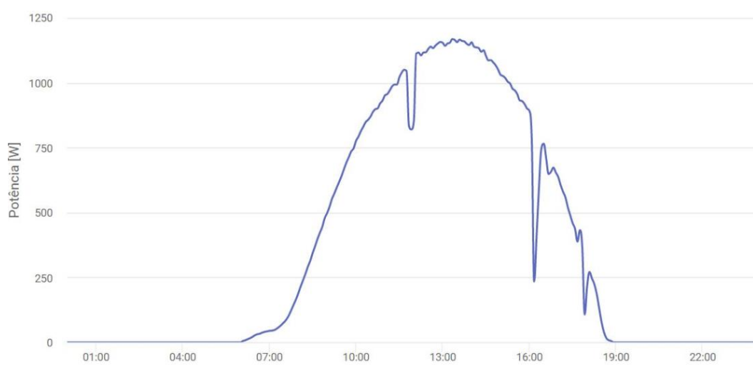
Figura 9 Geração fotovoltaica (W) durante o dia 21/12/2018.
