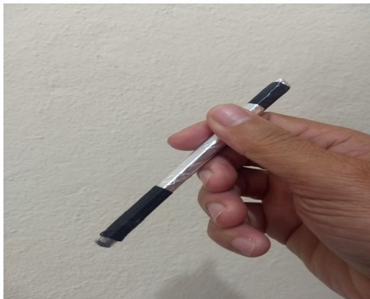
Figura 08. Caneta touch-screen confeccionada com material de baixo custo.
