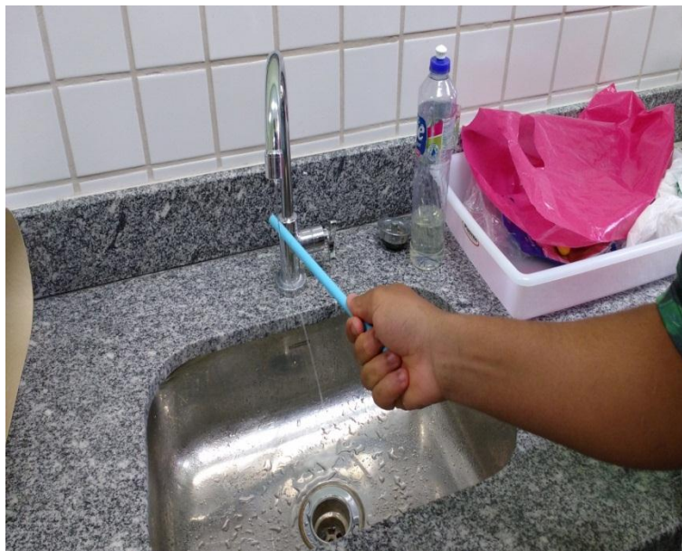
Figura 04. Tubo plástico eletrizado atraindo um filete d'água.
