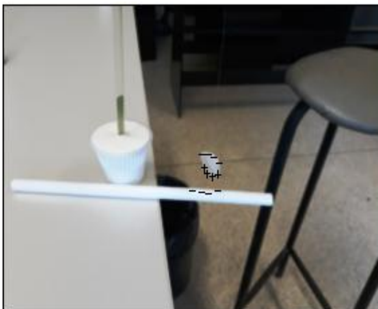
Figura 15. Polarização das cargas induzidas no disco de papel alumínio pela presença do canudo eletrizado negativamente.
