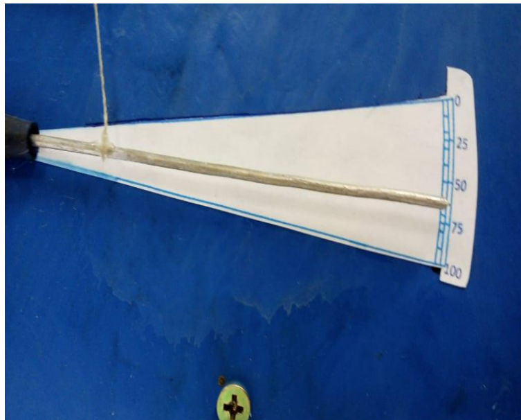
Figura 12. Medidor de umidade mostrando cerca de 60% de humidade.
