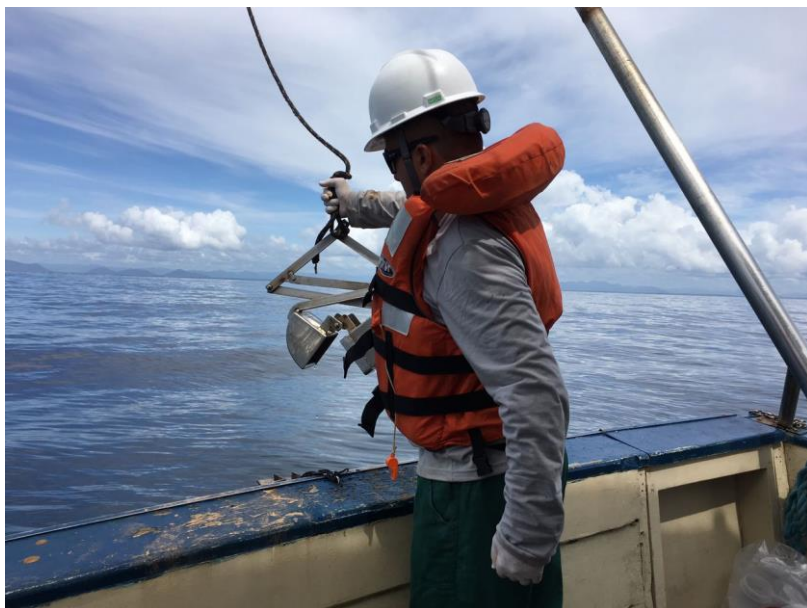
Figura 5. Lançamento da Draga Van Veen para coleta de amostras de sedimento.
