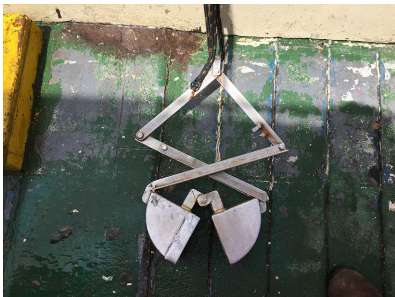
Figura 3. Draga Van Veen utilizada durante as coletas de campo.
