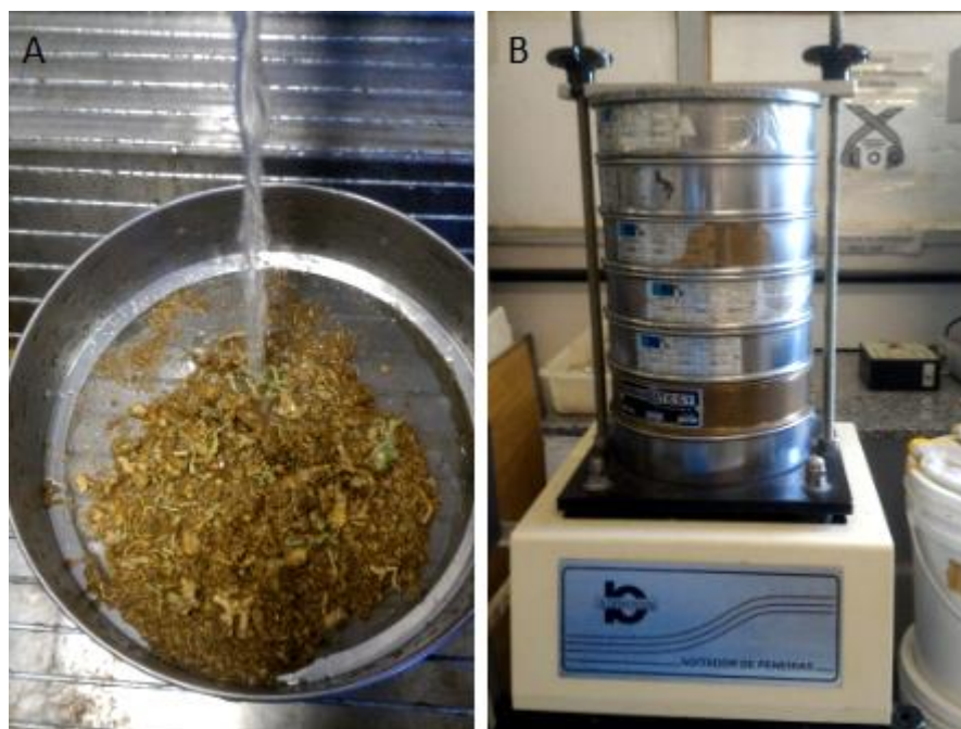
Figura 10. A) Peneiramento úmido e separação da fração lama da arenosa (limites das classes = 0,062mm de diâmetro). B) Peneiramento mecânico e separação das classes arenosas e cascalhos/grânulos.
