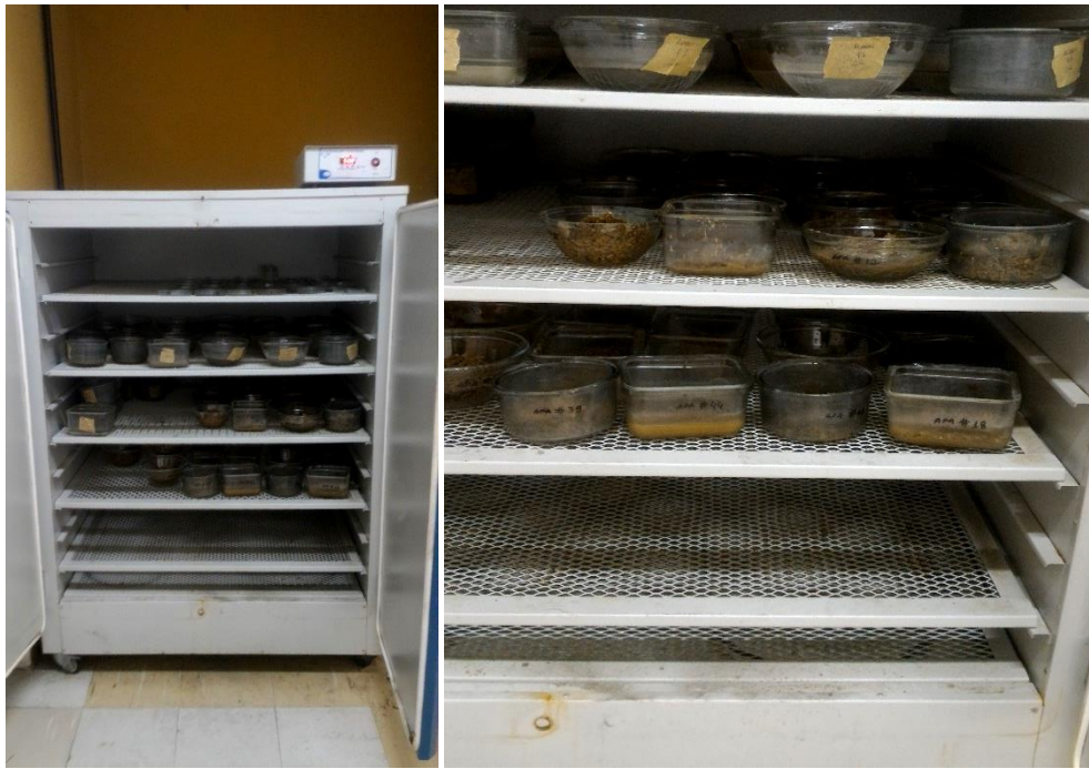
Figura 9. Amostras brutas de sedimento acondicionadas em estufa a 60°C para a secagem.
