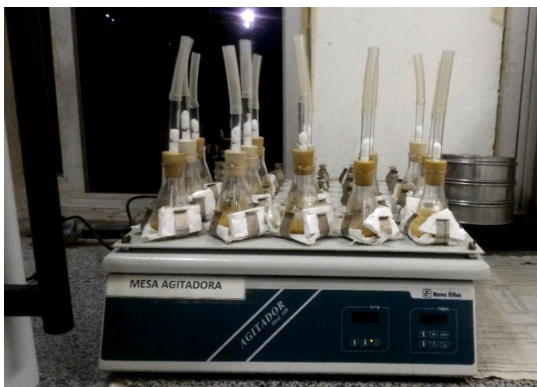
Figura 11. Mesa agitadora utilizada para análise do teor de \text{CaCO}_3 .
