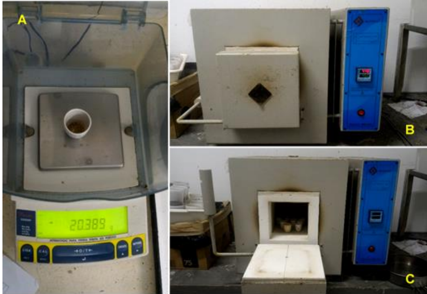
Figura 12. A) Peso da amostra de sedimento em cadinho para queima de MO. B e C) Queima de MO em mufla à 450°C.
