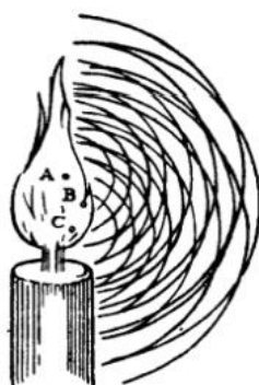
Figura 28: Desenho retirado do Tratado: ondas concêntricas a partir dos pontos A, B e C de uma vela.
