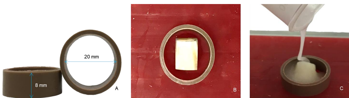
Figura 6 – (A) Cilindro de PVC utilizado na inclusão dos bloco de esmalte em resina acrílica; (B) Bloco de esmalte sobre cera utilidade com a superfície vestibular voltada para baixo no centro do cilindro de PVC; (C) Resina acrílica incolor quimicamente ativada é vertida no sobre o espécime de dente bovino.
