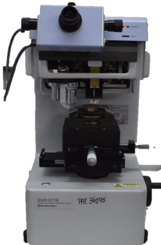
Figura 12 – Dispositivo utilizado para os ensaios de nanodureza (DUH-211S; Shimadzu Corporation, Kyoto, Japão).
