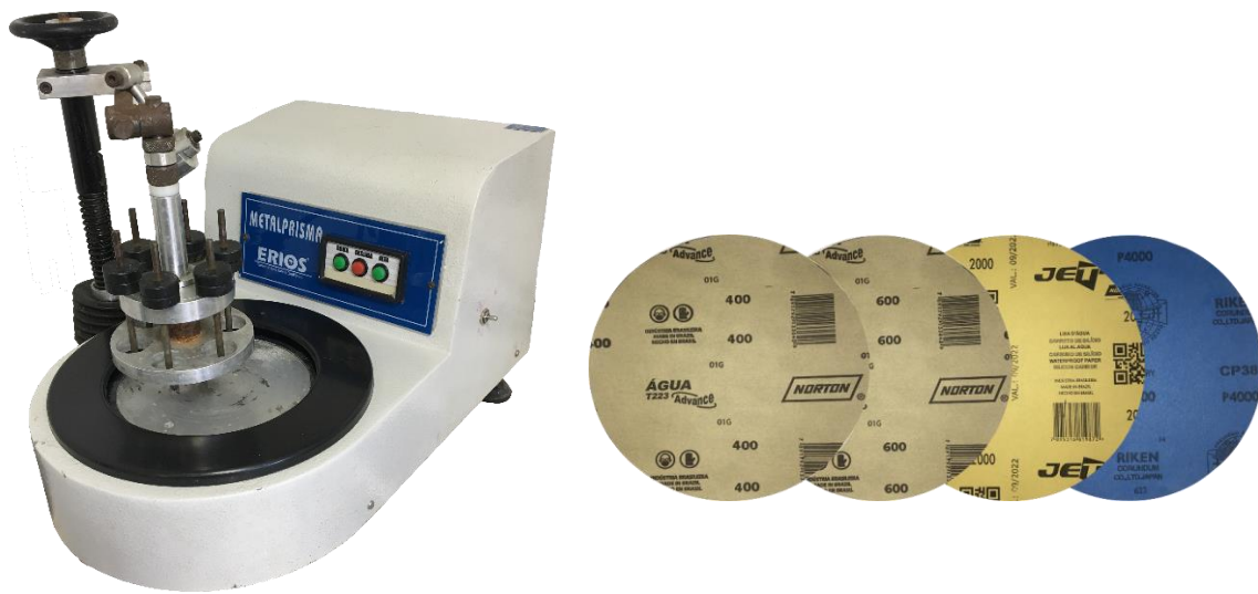
Figura 7 – Politriz e lixas de carbeto de silício (#400, #600, #2000 e #4000) na planificação e polimento da superfície do esmalte após embutimento.
