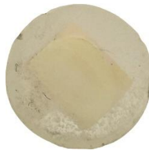
Figura 8 – Aspecto final Corpo de prova após polimento final com suspensão de alumina 3 \mu m.
