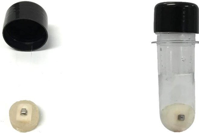
Figura 11 – Logo após a colagem os corpos de prova foram imersos em solução desmineralizante.
