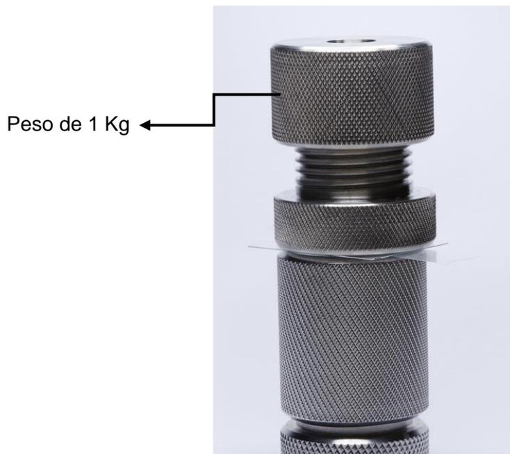
**Figura 10** - Pressão com peso de 1 Kg para escoamento do excesso de cimento e compactação adequada do material
