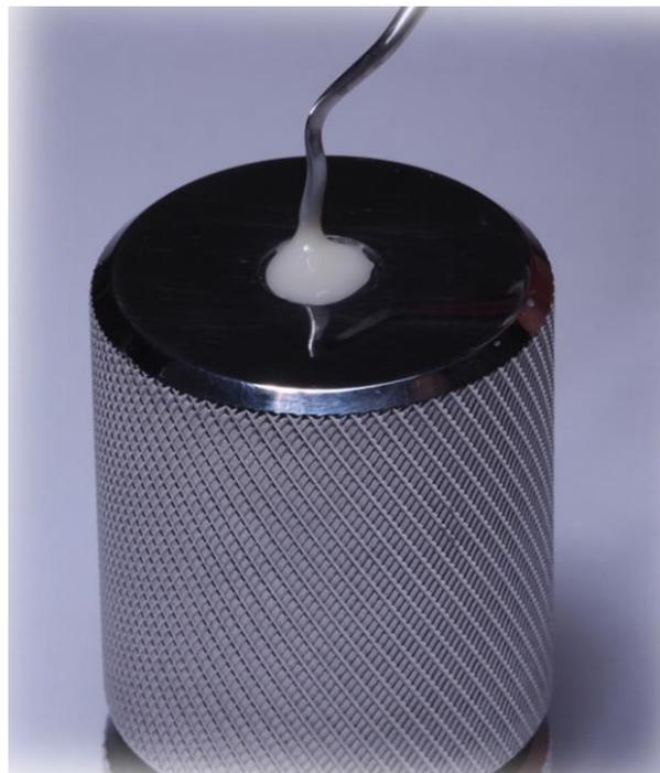
**Figura 8** - Aspecto do cimento resinoso após mistura e sua inserção na cavidade da matriz
