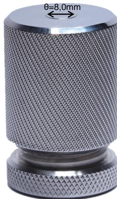
**Figura 6** - Matriz circular para confecção dos espécimes de cimento resinoso ( $\theta=8,0\text{mm}$ ;  $h=0,5\text{mm}$ )
