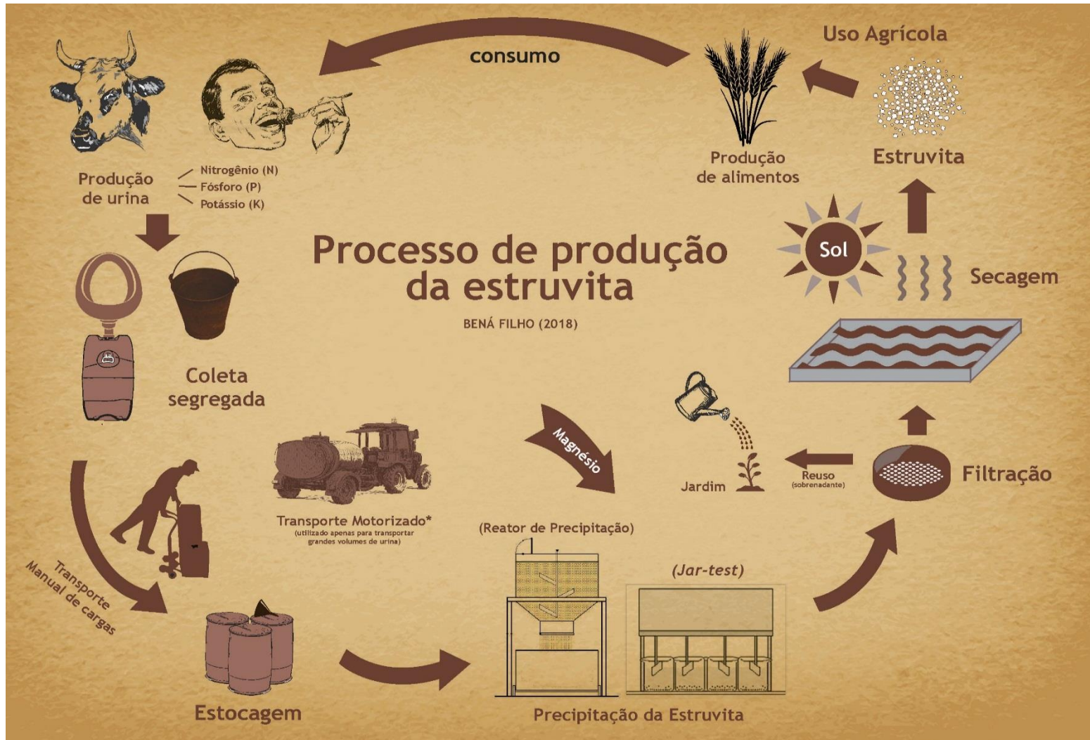
Fluxograma 2 - Processo de produção da estruvita em pequena escala
