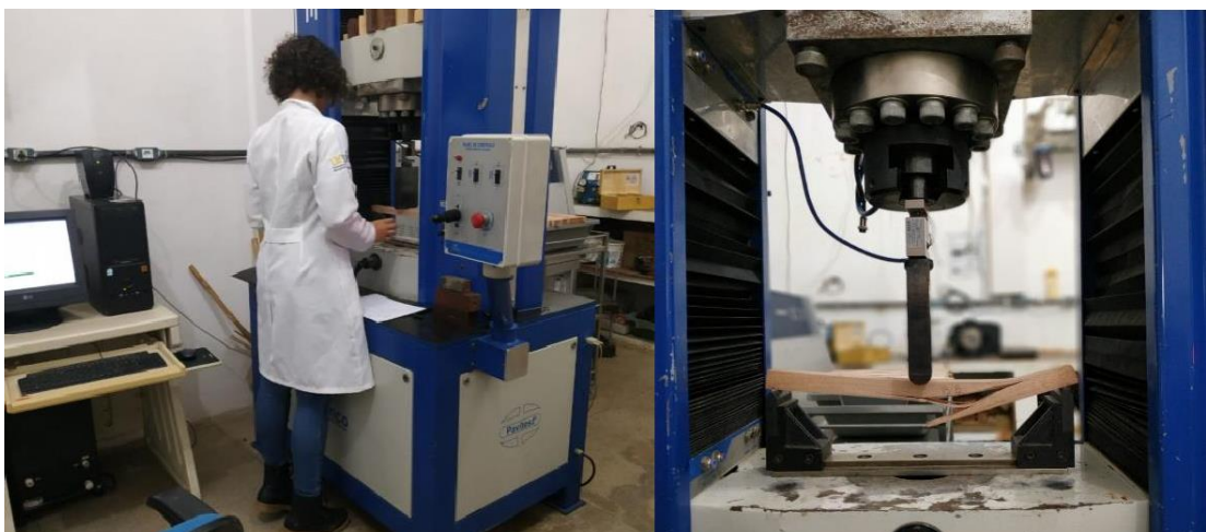
Figura 8 - Medição dos módulos de elasticidade estático e de ruptura da madeira.
