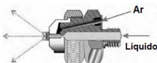
Figura 9. Bocal típico de aspersores de soluções aquosas [44].
