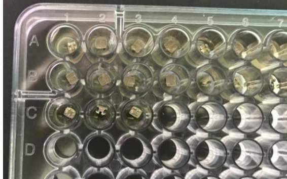
Figura 5 - Micropoços com bráquetes imersos em suspensão padronizada de S. mutans em caldo BHI.
