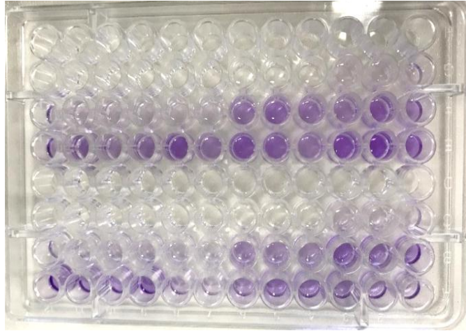
Figura 7 - Processo de descoloração do biofilme com solução de ácido acético 33%.
