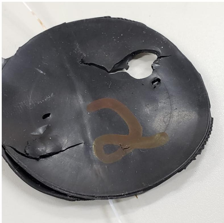
Figura 32 – Detalhes do diafragma produzido através do sistema de vulcanização. Esse diafragma é oriundo do teste 2.
