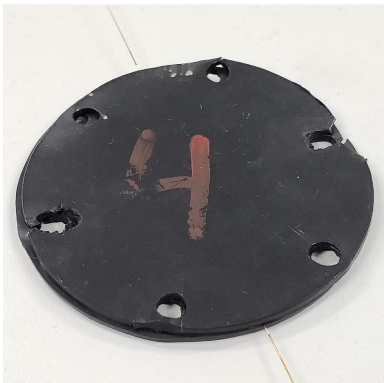
Figura 33 – Detalhes do diafragma produzido através do sistema de vulcanização. Esse diafragma é oriundo do teste 4.
