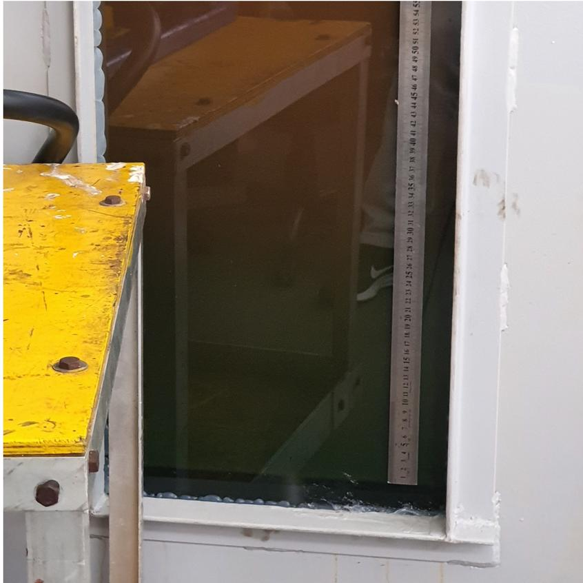
Figura 29 – Nível de referência que corresponde a zero centímetros dos testes no tanque contendo água e óleo.
