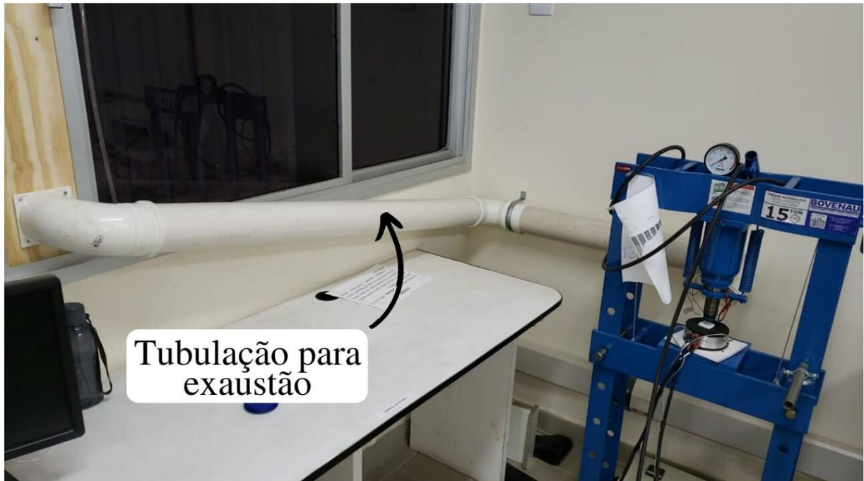
Figura 23 – Sistema de exaustão dos gases tóxicos provenientes do processo de vulcanização.
