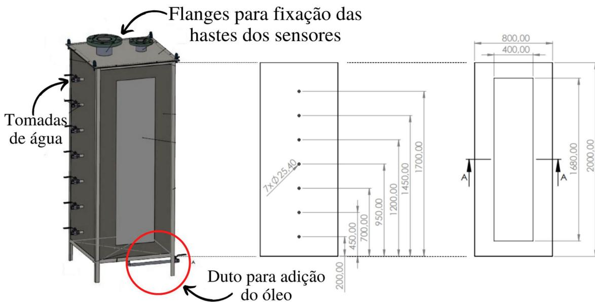
Figura 24 – Esquema com as medidas do tanque de testes do projetado para medições de nível de interface. Alguns pontos principais do tanque foram destacados.
