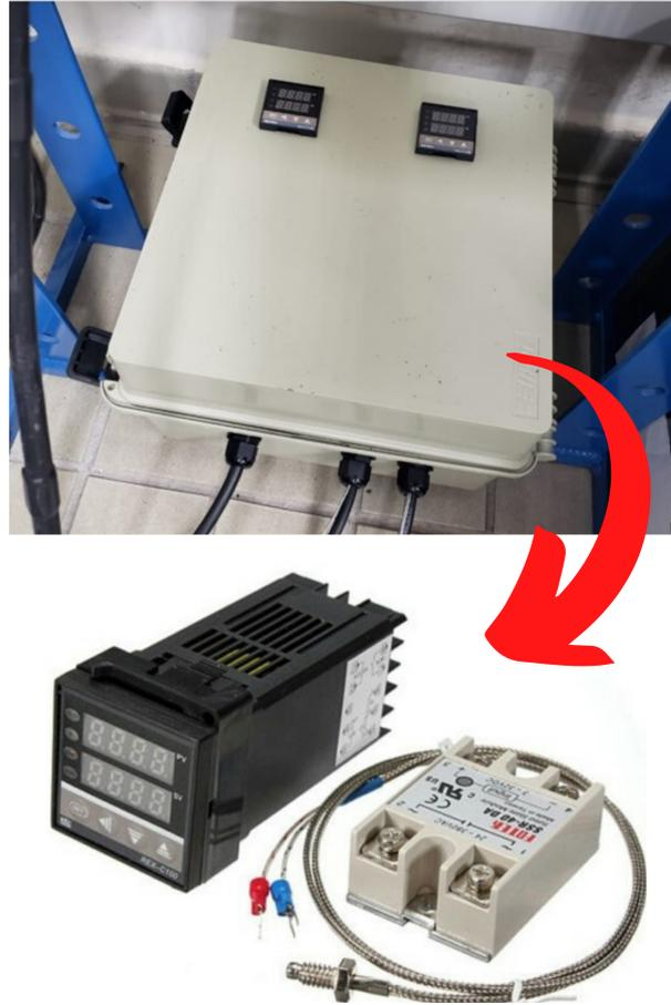
Figura 22 – Controlador de temperatura e relê utilizados para montagem do sistema de vulcanização.
