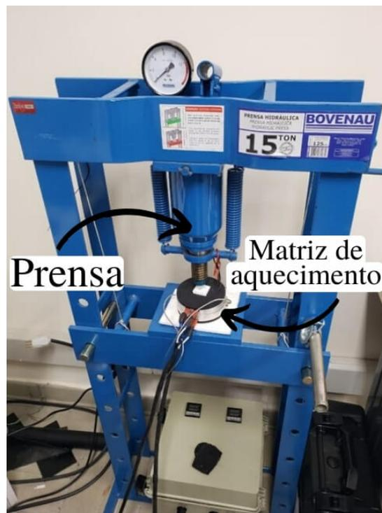
Figura 20 – Foto da prensa utilizada para montagem do sistema de vulcanização.
