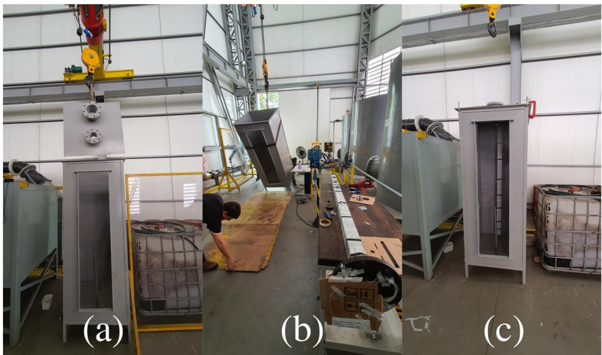
Figura 26 – (a) tanque sendo içado pelo guindaste para a colocação da haste contendo sensores; (b) tanque é inclinado para que haste contendo sensores seja inserido; (c) tanque posicionado após inserir haste contendo sensores.
