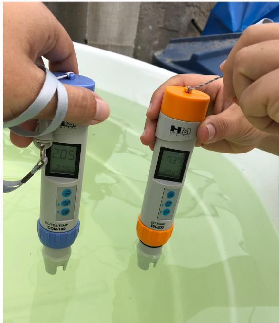
**Figura 4.** Medidores portáteis de pH e condutividade elétrica utilizados.
