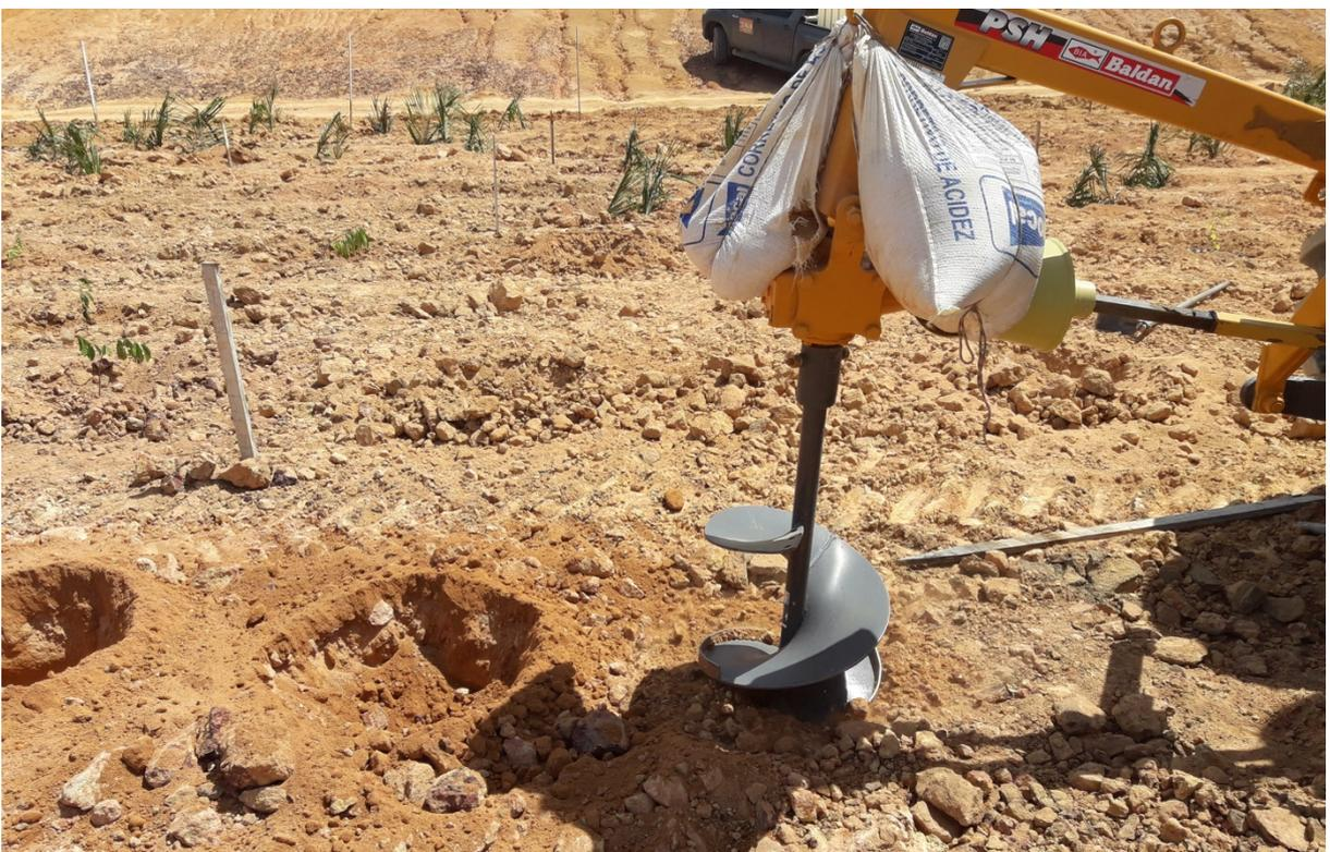
**Figura 3.** Abertura das covas para plantio com broca acoplada ao trator.
