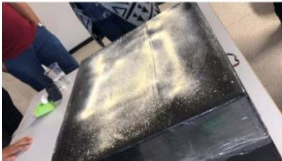
Figura 20: Visualização do comportamento dos grãos em diferentes frequências
