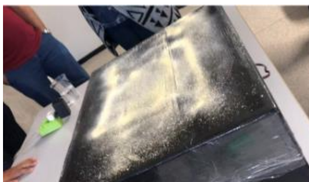
Figura 12: Aparato experimental com os grãos de trigo e fubá para visualização das ondas sonoras
