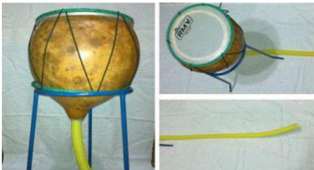
Figura 9 : Dispositivo para permitir que se possa ter uma percepção visual de uma onda sonora.
