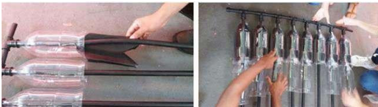
Figura 19 - Etapa de colocação das caixas de leite.
